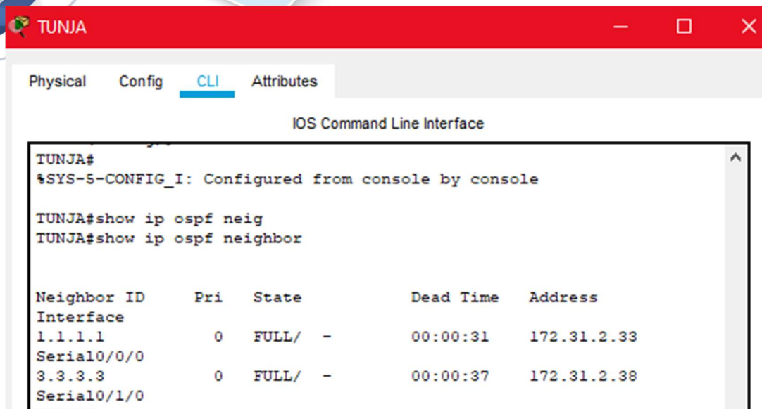
Ilustración 52: Comando Show Ip ospf neighbor en router de Tunja
