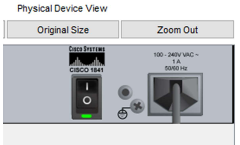
Ilustración 2: Apagado de router cisco 1841
