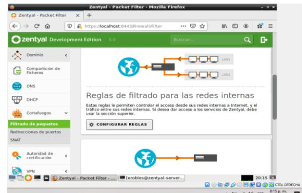
Figura 52 – Configuración cortafuegos de Zentyal – Fuente propia
