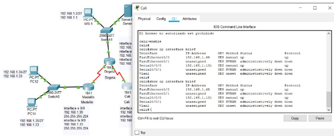
b. Despues de cargada la configuración en los dispositivos, verificar la tabla de enrutamiento en cada uno de los routers para comprobar las redes y sus rutas.
