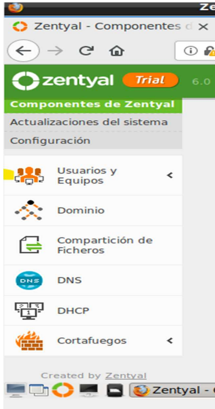
33. Módulos instalados en el servidor Zentyal.
