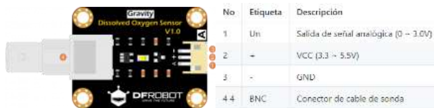
Figura 28. Características de los puertos del sensor recuperado de: https://wiki.dfrobot.com/Gravity Analog Dissolved Oxygen Sensor SKU SEN0237 (DFRobot, 2019)
