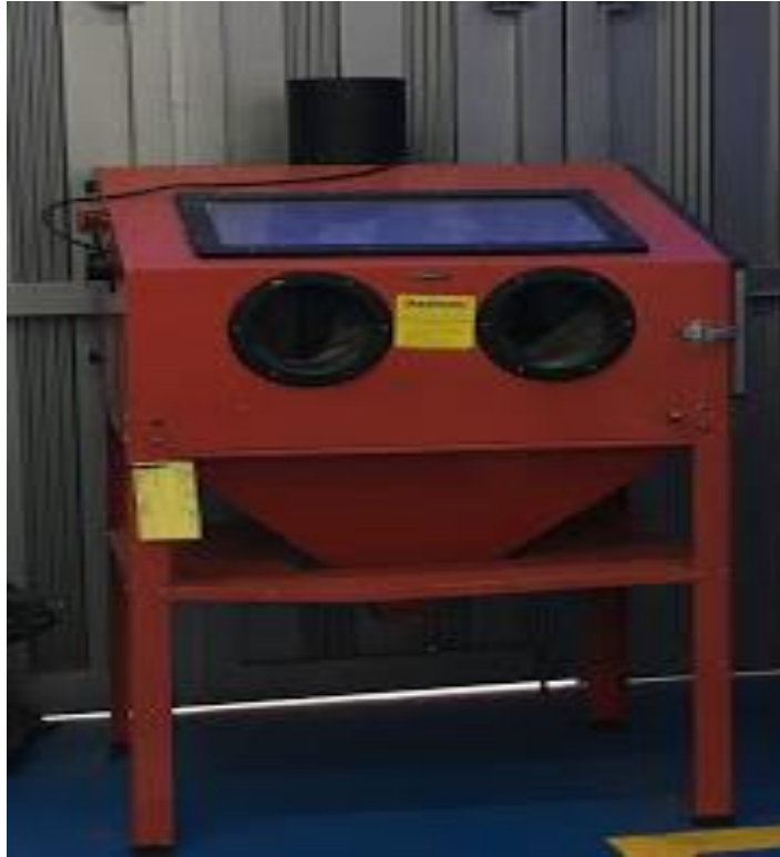
Figura 8. Equipo para Sandblasting para limpieza de piezas. Autor, 2019
