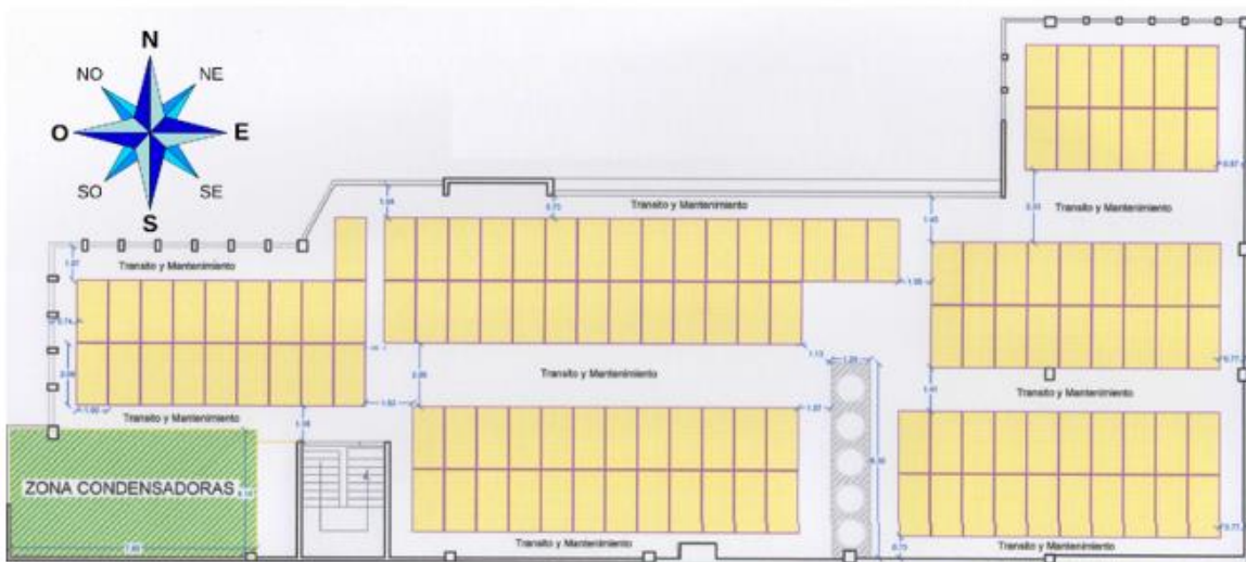
Ilustración 15. Planteamiento de distribución de paneles fotovoltaicos
