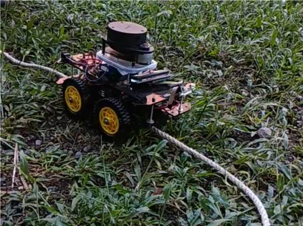
Figura 25. Plataforma de visión artificial siguiendo línea en césped.
