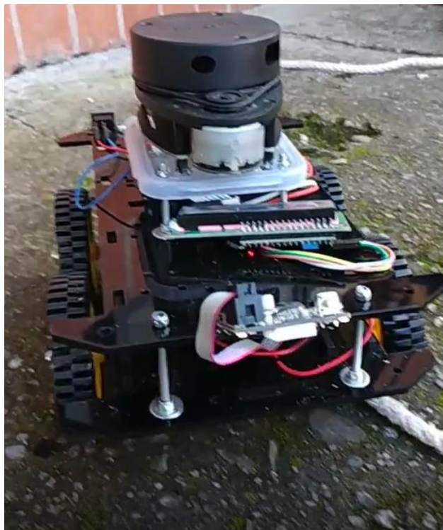
Figura 24. Plataforma de visión artificial siguiendo línea en asfalto.
