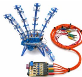
Figura 5 Hardware desarrollado con su respectivo electromiógrafo incorporado. (Back Yard Brains).
