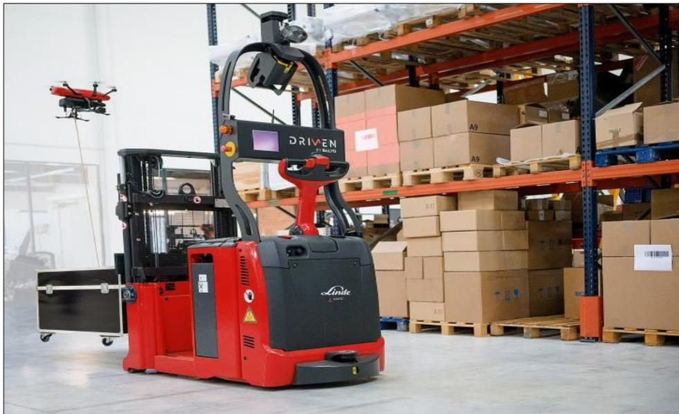
Figura 14. Dron Flybox y Apilador automático
