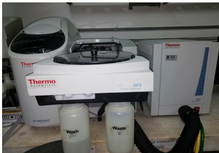
Figura 31. Espectrofotómetro de absorción atómica (AAS) UT.
