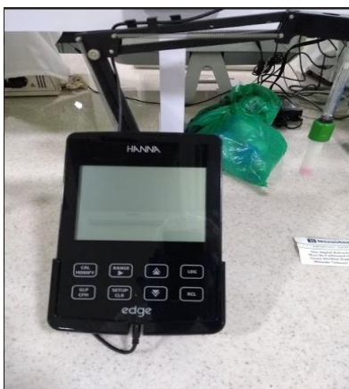
Figura 23. Potenciómetro HANNA edge Conductividad Fuente: Autores
