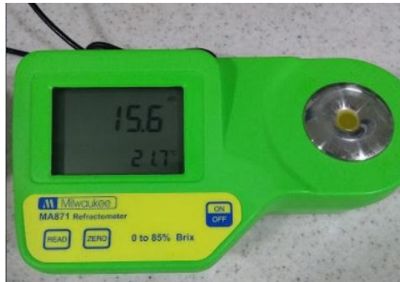
Figura 25. Equipo Refractómetro MIWOUKEE Fuente: Autores
