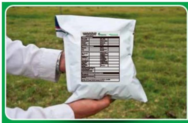
*Ilustración 12. Bolsa plástica utilizada para el envío de muestras de suelo al laboratorio para análisis de fertilidad.*
