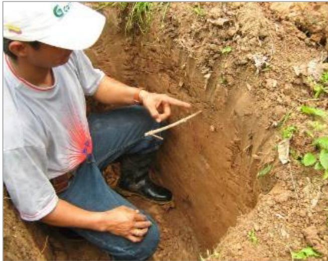
*Ilustración 1. Calicata para la verificación de la profundidad y perfil del suelo. Cunday - Tolima*
