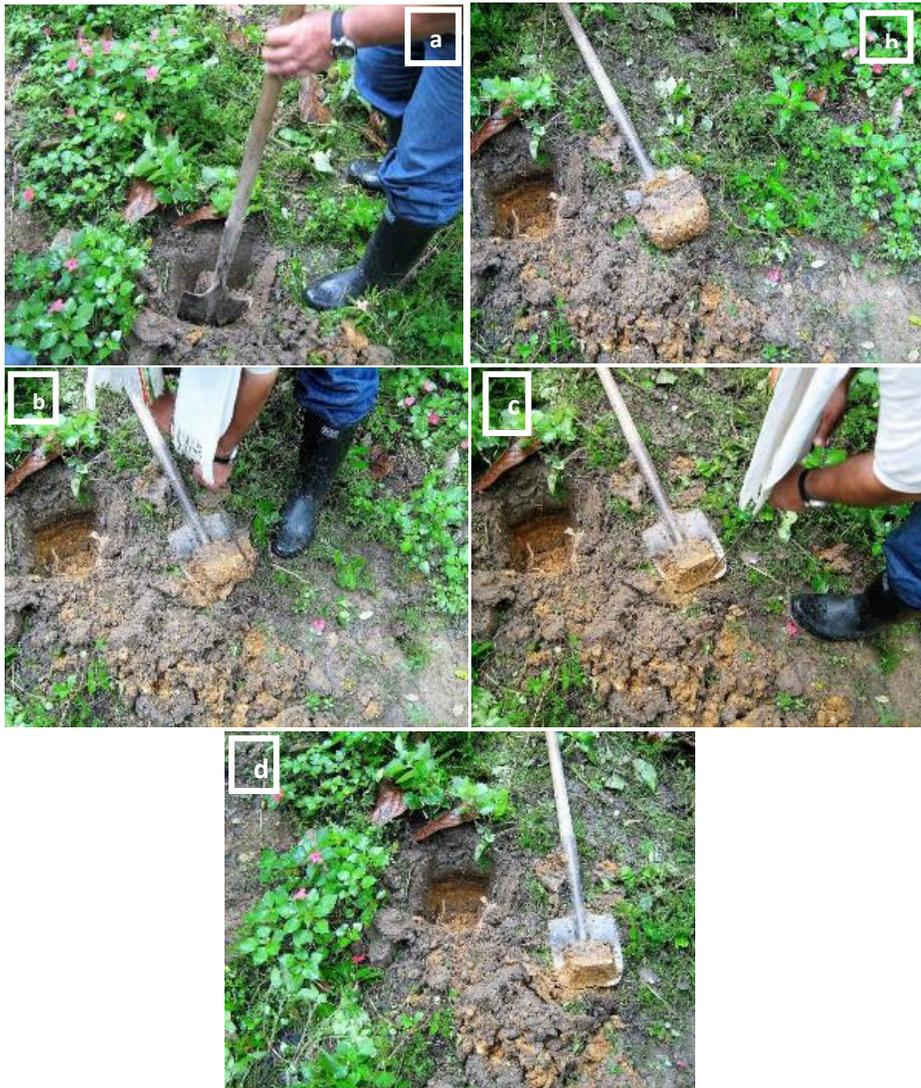
*Ilustración 11. Procedimiento secuencial para obtención de una submuestra de suelo. a) Limpieza y elaboración del hueco. b) Submuestra de suelo sin preparar. c) Eliminación de bordes laterales. d) Eliminación de bordes superior e inferior e) Submuestra lista*
