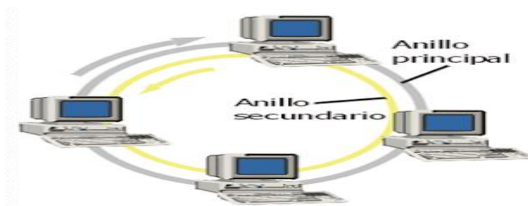
Figura 4. Topología de una red de anillo.
