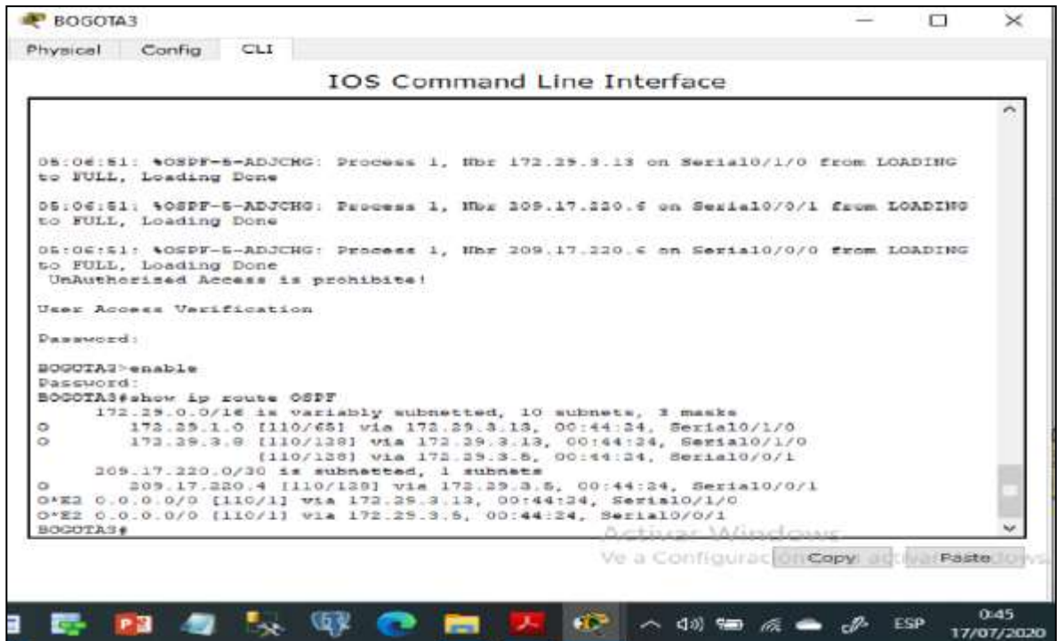
Figura 38. Verificación de OSPF para BOGOTA3
