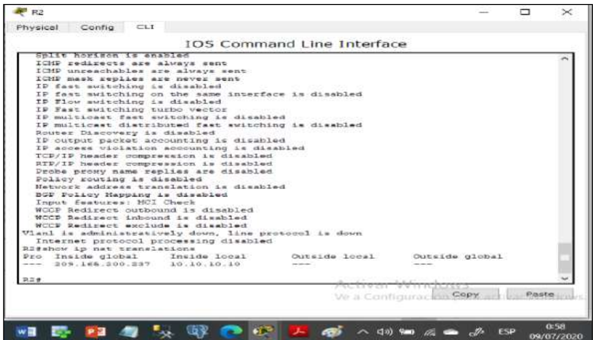
Figura 20. Aplicación del comando show ip nat translations
