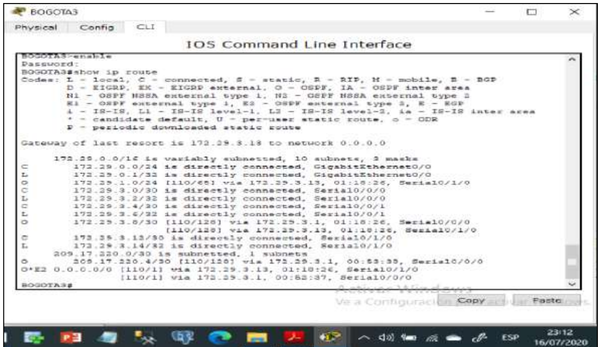
Figura 29. Tabla de enrutamiento BOGOTA3
