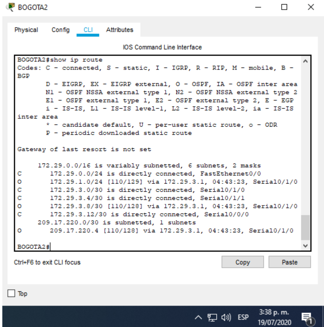
Figura 25. Verificación tabla enrutamiento en BOGOTA2.
