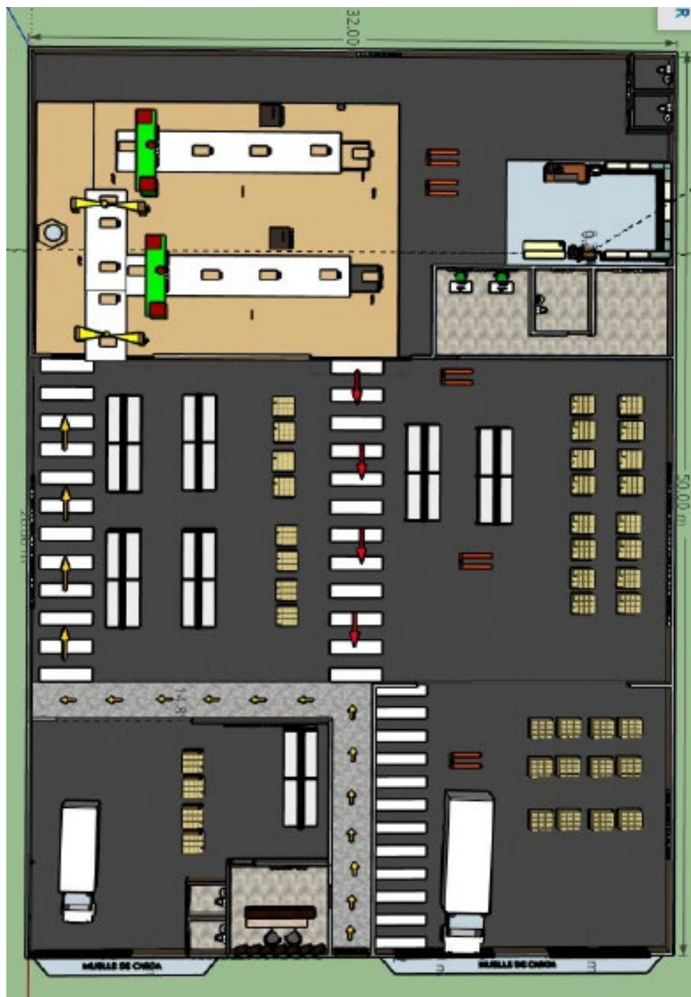
Figura 26. Plano de layout propuesta. Fuente de elaboración propia.
