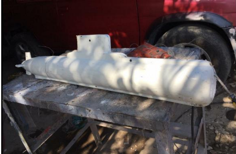
Ilustración 33: Silueta en fibra de vidrio. Fuente: Autoría propia.
