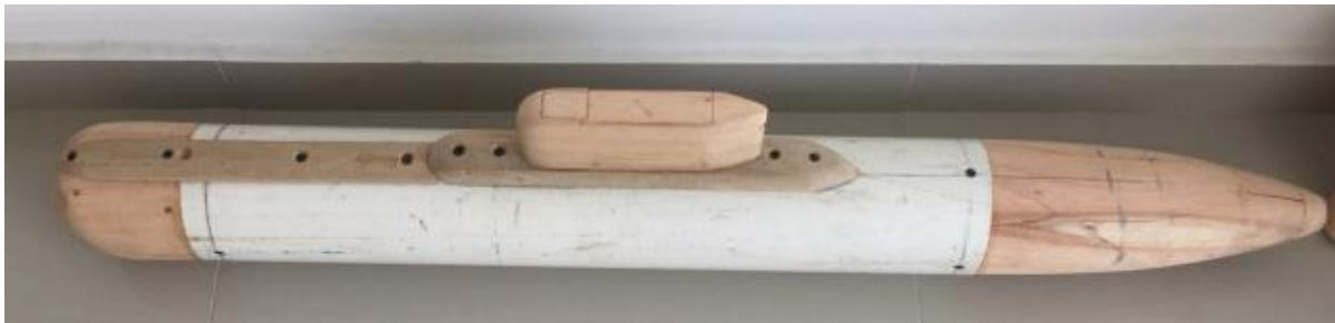
Ilustración 32: Molde del Submarino para llevarlo al fibrero. Fuente: Autoría propia.
