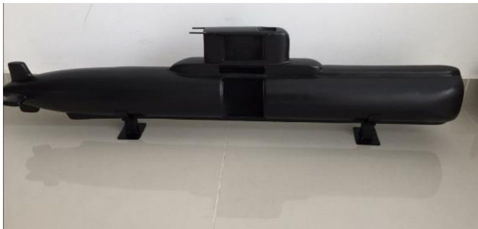
Ilustración 36: Terminado en fibra de vidrio. Fuente: Autoría propia.
