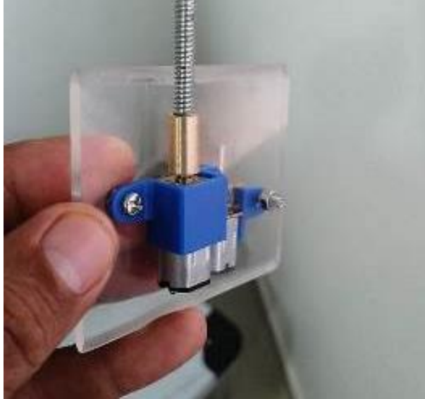
Ilustración 28: Acople del mástil y motor a través de un bocín. Fuente: Autoría propia.
