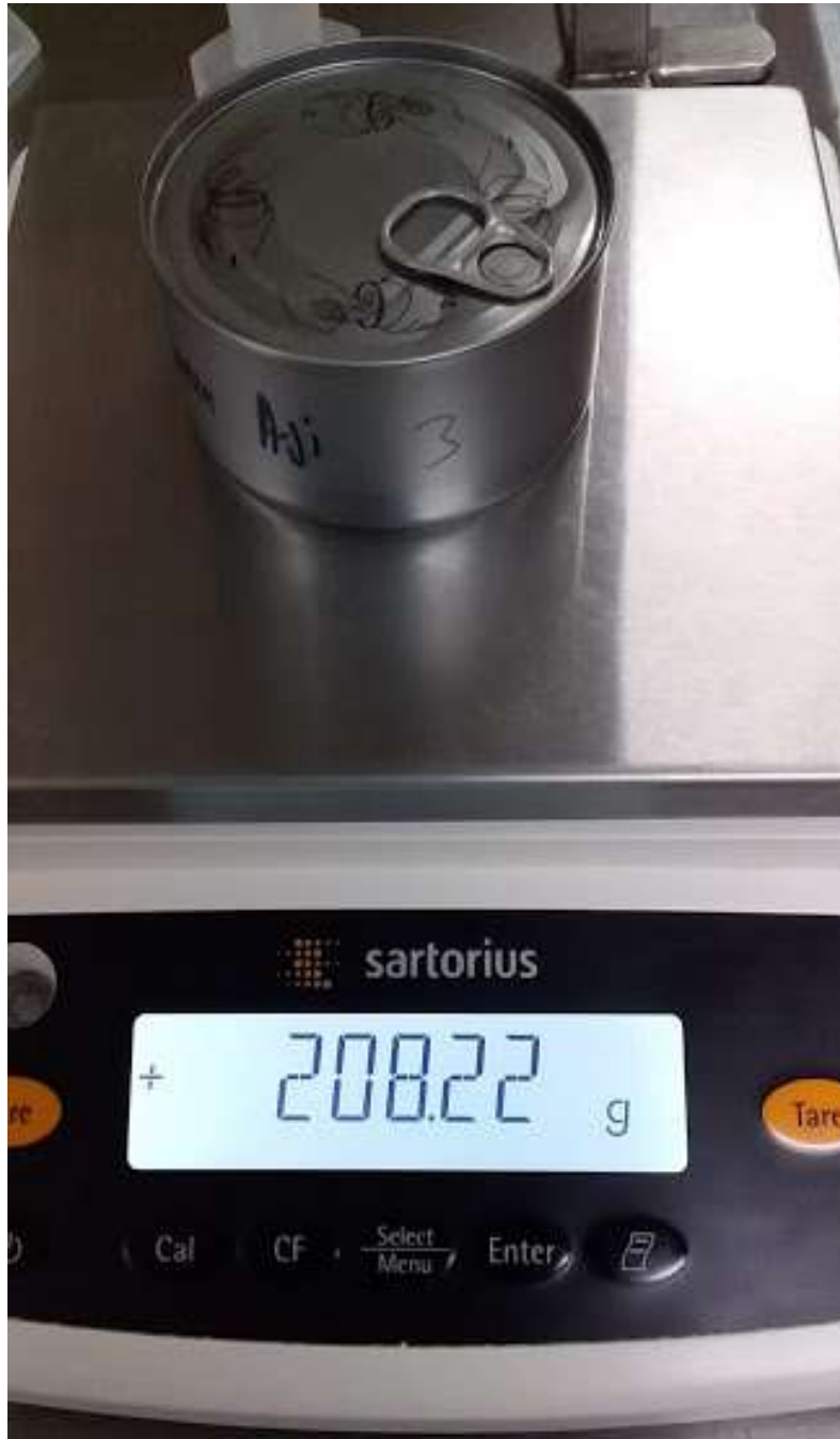
Medición de masa, para determina el peso bruto individual para establecer peso neto
