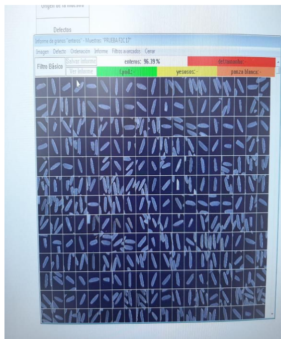
Figura 12. a. analizador de granos s21. b imagen arrojada por el analizador de granos para la interpretación de resultados. Fuente: Autor
