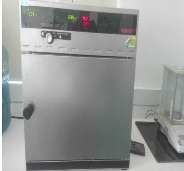
Figura 7. a. cosecha de semilla F1. b. horno de secado para bajar el contenido humedad de semilla F1 para el análisis en laboratorio. Fuente: Autor
