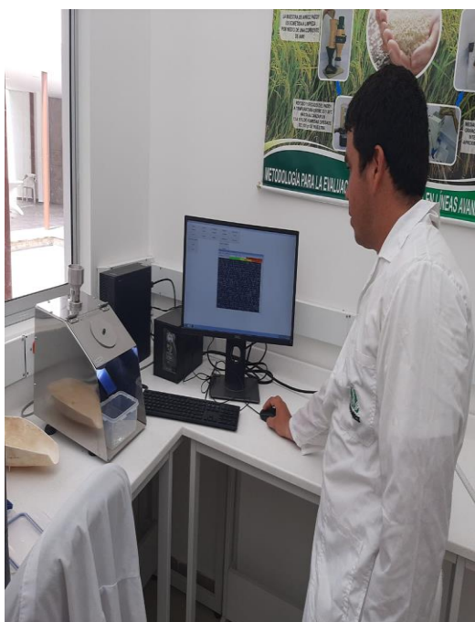
Figura 12. a. analizador de granos s21. b imagen arrojada por el analizador de granos para la interpretación de resultados. Fuente: Autor
