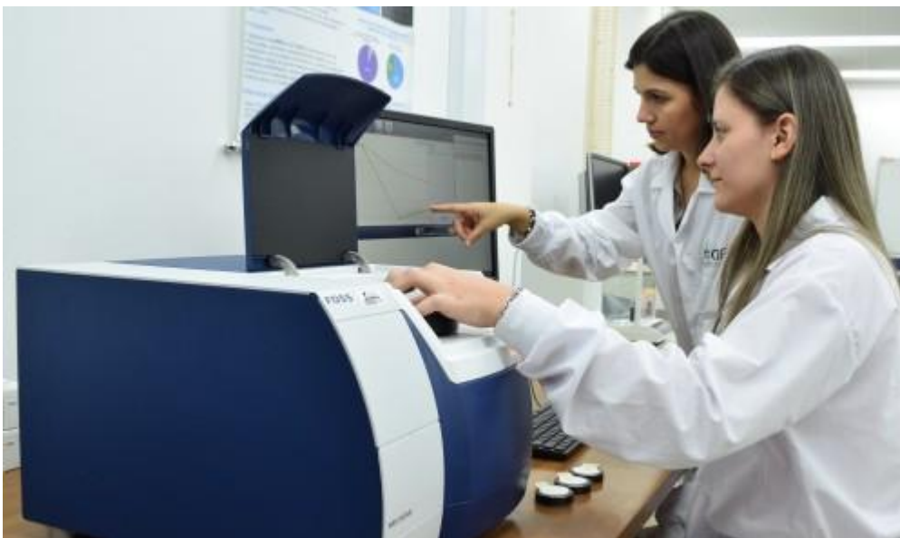
Figura 13. NIRS ds2500 equipo utilizado para análisis de contenido de amilosa. Fuente: https://flar.org/nirs-ds2500-el-equipo-mas-esperado-del-2016-ya-esta-aqui/
