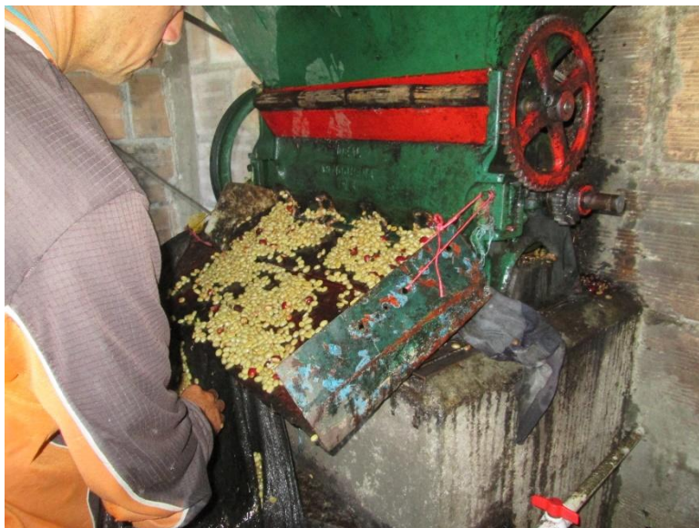
Fotografía 4. Proceso de despulpado de café o eliminación del exocarpio Foto: Autor Catalina Ayala
