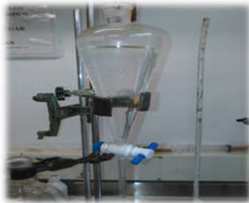
Fotografía 7. Montaje Embudo de decantación para separación del aceite esencial. Morales J.
