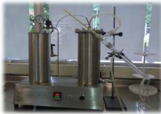
Fotografía 5. Montaje equipo Hidrodestilación. Morales J.
