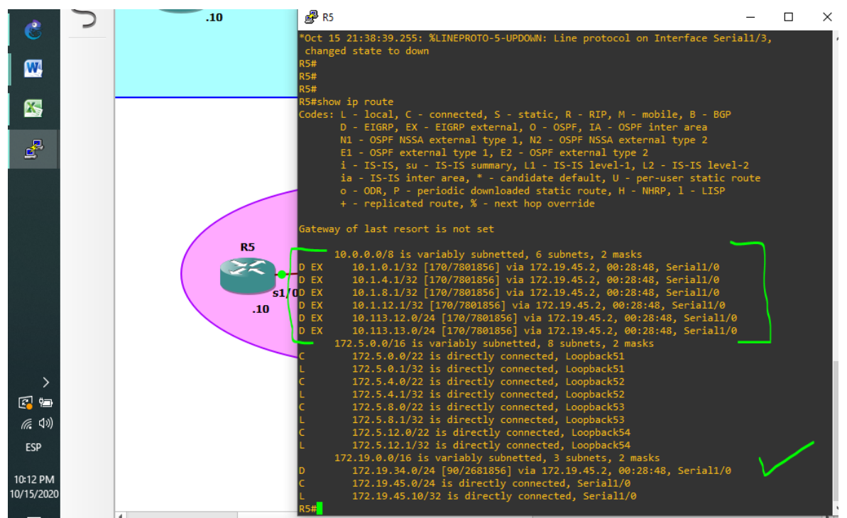
Figura 6. Simulación de escenario 1, SHOW IP ROUTE en R5
