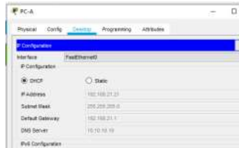
Figura 7. Verificar que la PC-A haya adquirido información de IP del servidor de DHCP
