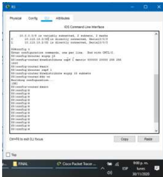
Ilustración 7. 5. Configure R3 para redistribuir las rutas EIGRP en OSPF.
