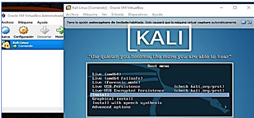
Figura 7 Instalar sistema Kali Linux desde imagen ISO
