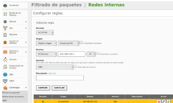
Figura 8. Reglas de filtrado en el firewall
