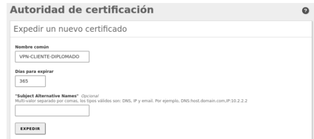
Fig. 51. Consola de Autoridad de Certificación, creando un certificado para el servidor VPN
