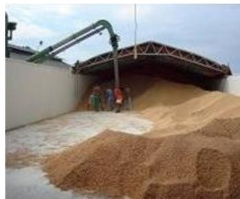
***Ilustración 50. Descargador neumático Neuero (200Ton/H), Sociedad Portuaria de Barrancabermeja S.A.***
