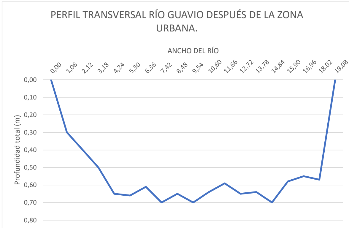
Figura 8: Perfil transversal del Río Guavio después del vertimiento
