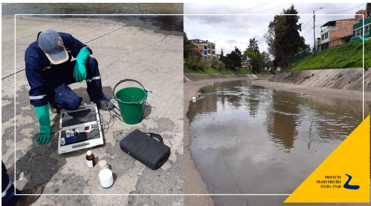
Ilustración 17 Medición del oxígeno disuelto en campo
