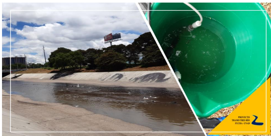
Ilustración 24 Toma de muestra para medición de pH en campo
