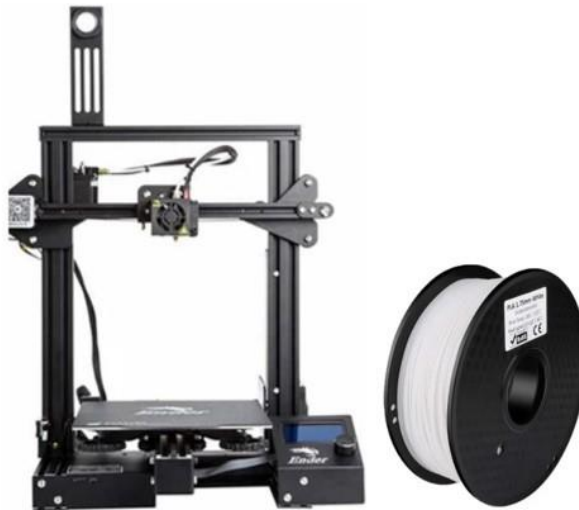
Ilustración 15 Impresora y filamento PLA utilizado para las piezas
