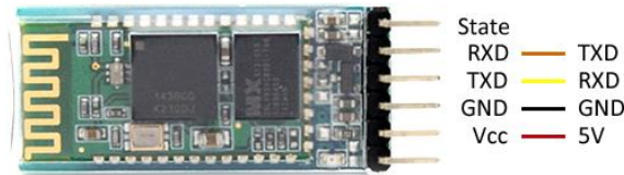
Ilustración 5 Esquema eléctrico Módulo Shield Bluetooth HC-05.
