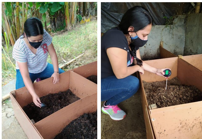
Figura 7. Medición de los parámetros pH, Temperatura y contenido de humedad
