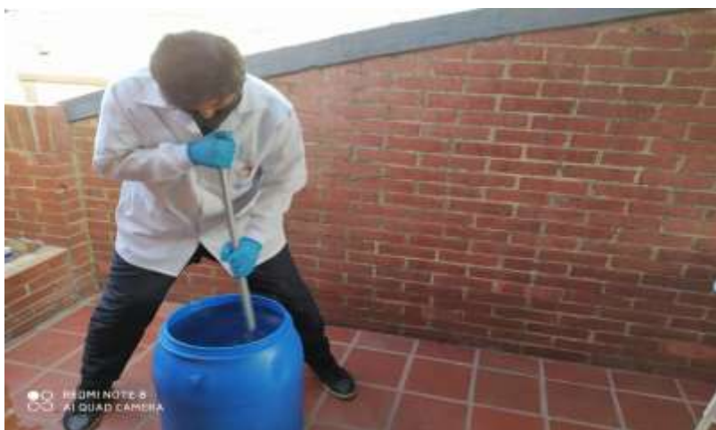
Fotografía 2: Vaciado y mezclado de la muestra en un recipiente de capacidad de 100 lts
