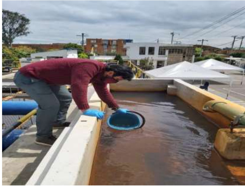
Fotografía 1: Toma de la muestra, para el ensayo de jarras
