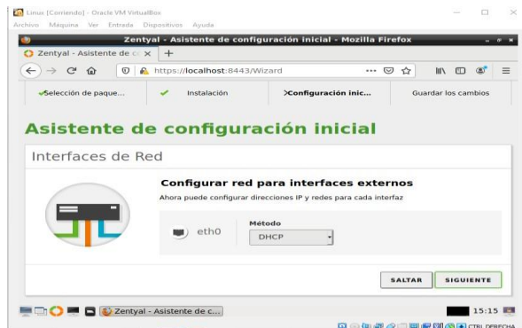
Figura 21. Configurar de red método DHCP.
