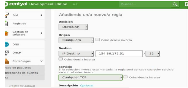
Figura 59. Configuración de reglas para la Ip 154.86.172.51
