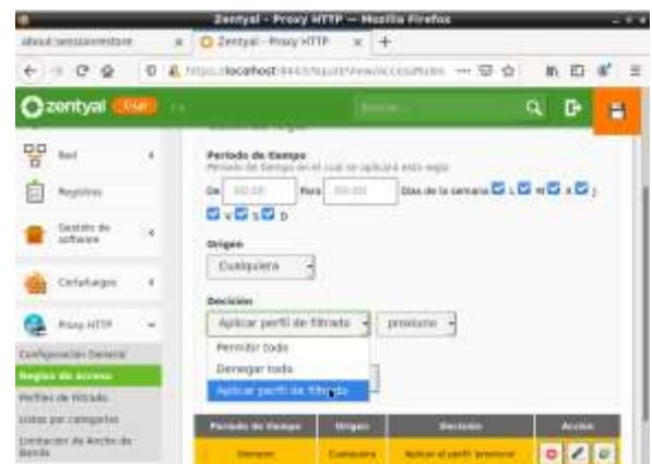
Figura 44. Selección de opción Aplicar perfil de filtrado, selección de perfil creado y cambiar.
