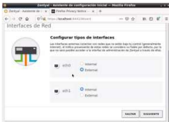
Figura 34. Configuración de interfaces, eth0 zona roja, y la eth1 zona verde.
