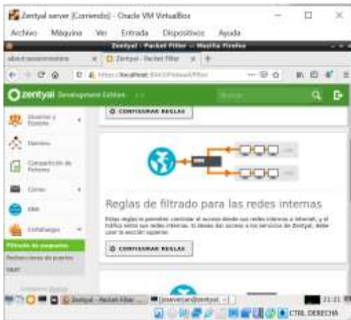
Figura 58. Nos dirigimos al zentyal y ubicamos el cortafuegos, principalmente en las reglas de filtrado para redes internas
