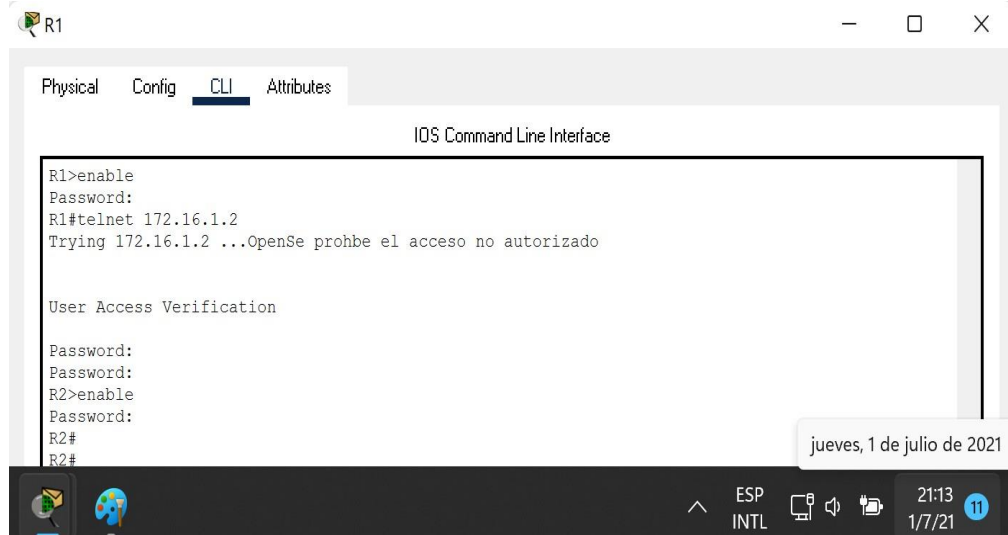
Figura 48. Verificación de funcionamiento de acceso de ACL desde R1.
