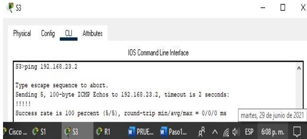
Figura 33. Verificación de conectividad entre S3 a R1 (VLAN23).
