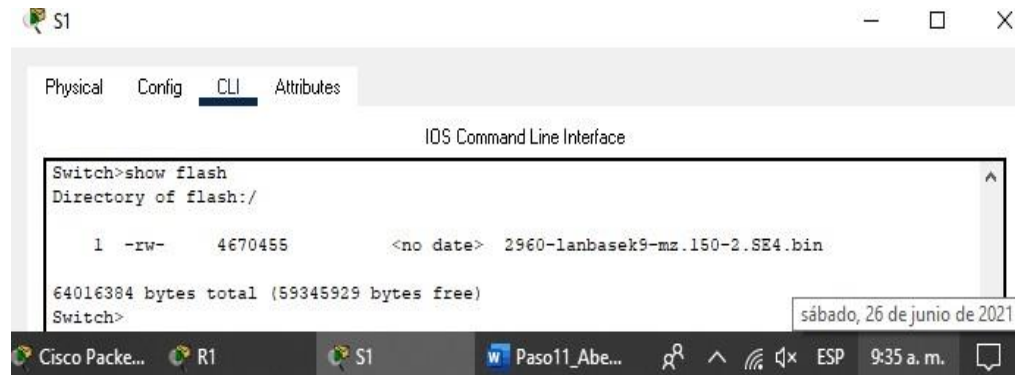
Figura 25. Verificación que no existe la base de datos VLAN en la memoria flash.
