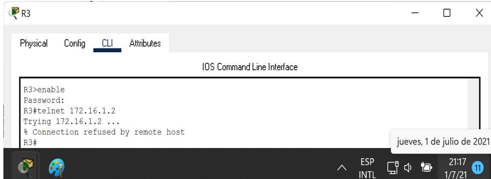
Figura 49. Verificación de restricción de acceso de ACL desde R3.
