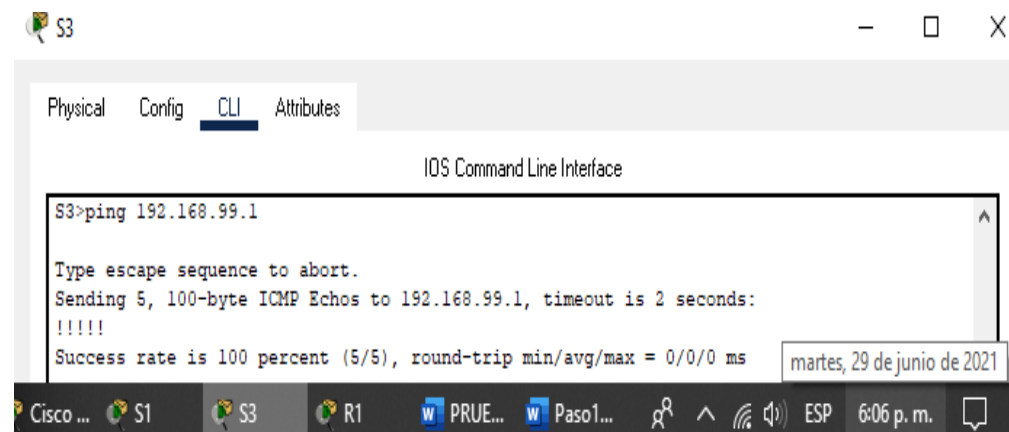
Figura 31. Verificación de conectividad entre S3 a R1 (VLAN99)
