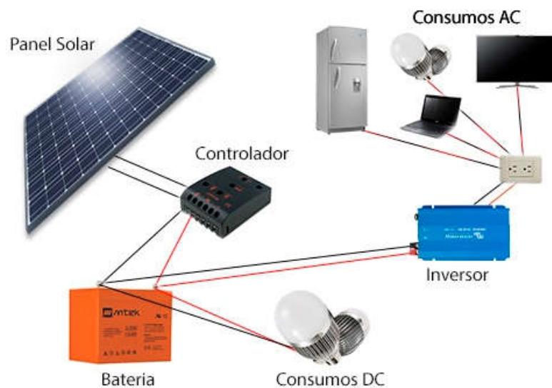
Imagen 2: Sistema Panel Solar Fotovoltaico
