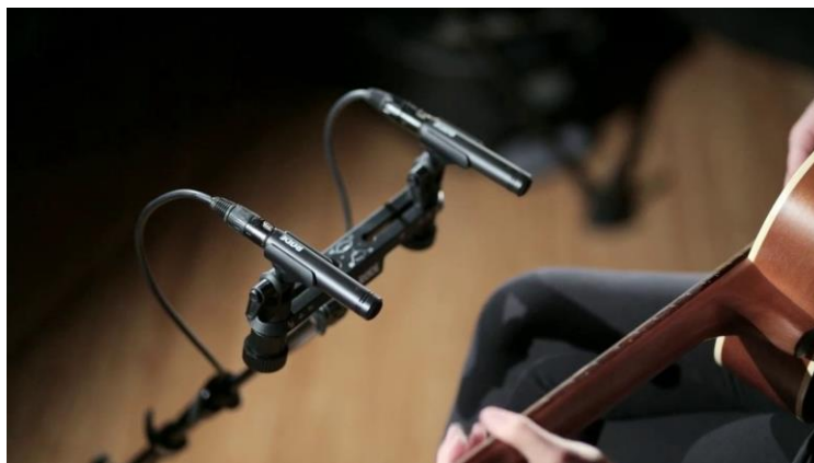
Figura 4. Técnica de microfonomía stereo par espaciado AB
