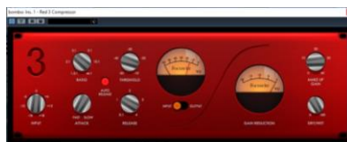
Figura 13. Parámetros de un compresor
