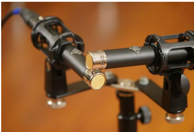
Figura 5. Técnica de microfonía stereo XY par coincidente
