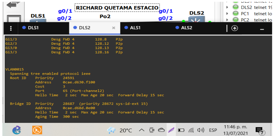
Figura 38. Verificación spanning tree prioridad vlan 15 en DLS2
