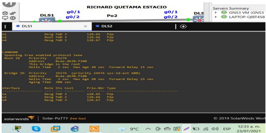
Figura 47. Verificación de configuración spanning tree DLS1 VLAN 600.
