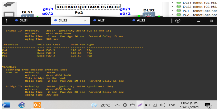
Figura 39. Verificación spanning tree prioridad vlan 100 en DLS2
