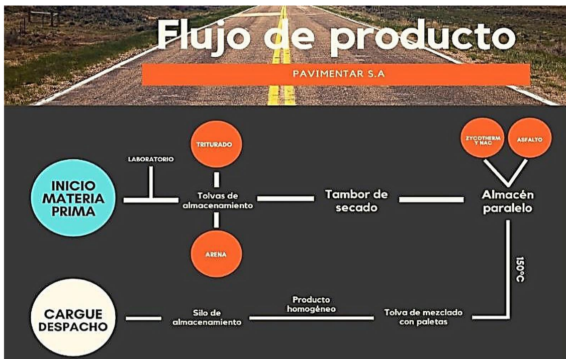
Ilustración 8– Diagrama de flujo de producto Pavimentar S.A.
