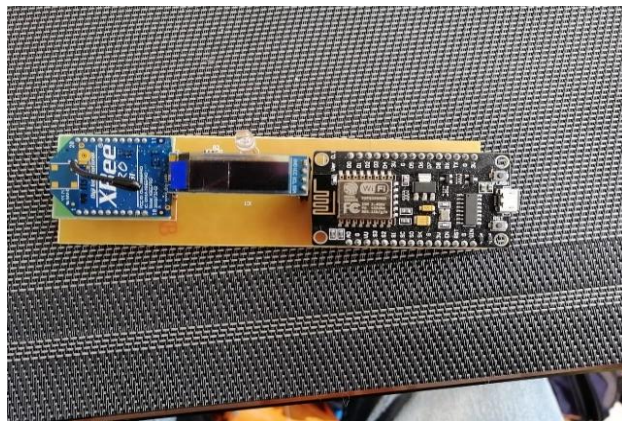
Figura 18. Integración módulos en tarjeta desarrollada del dispositivo esclavo Fuente: Elaboración propia
