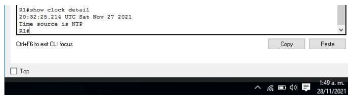
Ilustración 47 Verificación NTP en R1
