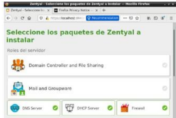
Figura 38. Instalación componente Firewall
