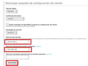
Figura 104. Seleccionamos el tipo de cliente Windows, también se seleccionará los certificados que utilizarán los clientes, se puede agregar un instalador de OpenVPN y se establece las direcciones IP externas a las que deben conectarse los clientes VPN y le damos clic en Descargar.
