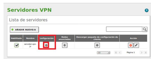
Figura 96. Le damos clic en el icono de configuración para entrar a configurar nuestro servidor VPN.
