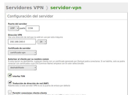
Figura 97. Los siguientes parámetros de configuración se agregan automáticamente y se pueden cambiar si es necesario: puerto / protocolo, certificado y dirección de red. El protocolo de conexión con el servidor será UDP con el puerto 1194, teniendo como dirección de red 192.168.160.0 /24; las direcciones de red VPN se asignan tanto al servidor como a los clientes.
