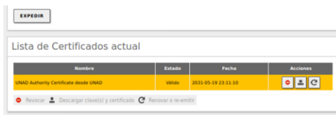
Figura 92. Ya creado el certificado, nos aparecerá en la lista de certificados, estando disponible para el administrador y el resto de los módulos, donde se podrá realizar distintas acciones con ellos como lo son: Descargar las claves públicas, privada y el certificado, Renovar un certificado, Revocar un certificado, Reexpedir un certificado previamente revocado o caducado.
