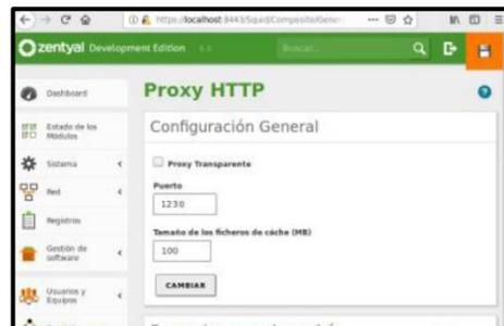
Ilustración 48. Configuración general del proxy con puerto 1230
