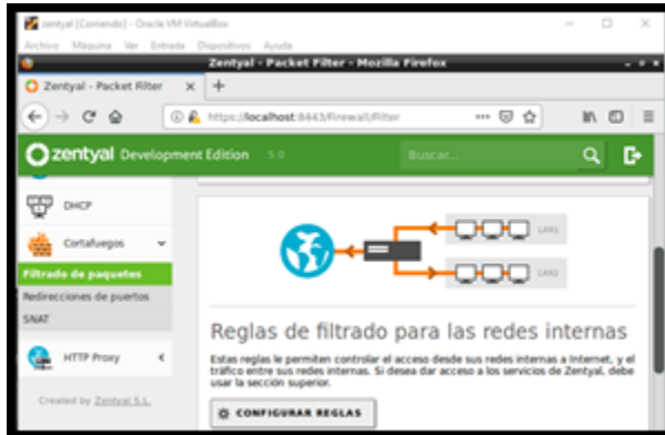
Figura 56. Configuramos la regla del cortafuego en Reglas de filtrado para redes internas.
