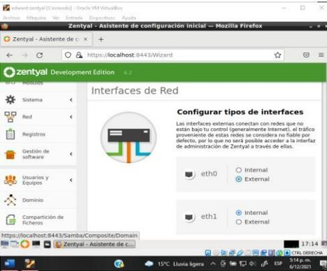
Figura 16. configuración interfaces de red en modo DHCP.
