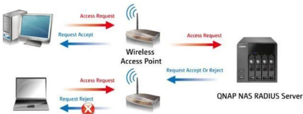
Figura 6 funcionamiento RADIUS SERVER 1
