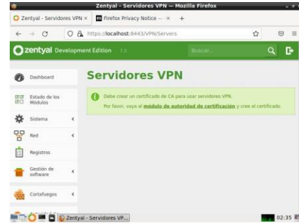
Figura 67: El sistema solicita que se debe crear un certificado de CA para usar servidores vpn, por lo que se debe acceder al módulo de autoridad de certificación para crear el certificado.
