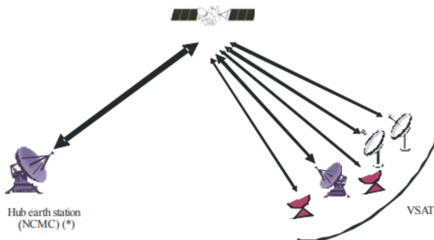
Ilustración 6: Red VSAT topología estrella
