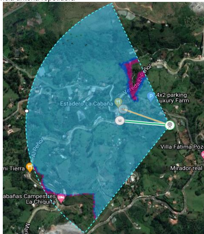
Ilustración 31: Nivel de potencia antena repetidora
